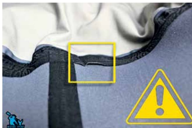
TERMOSSALDATURA SOLLEVATA: DA QUESTO PUNTO L'ACQUA POTRÀ ENTRARE.
