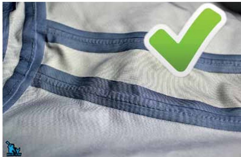
TERMOSSALDATURE IN OTTIME CONDIZIONI.
